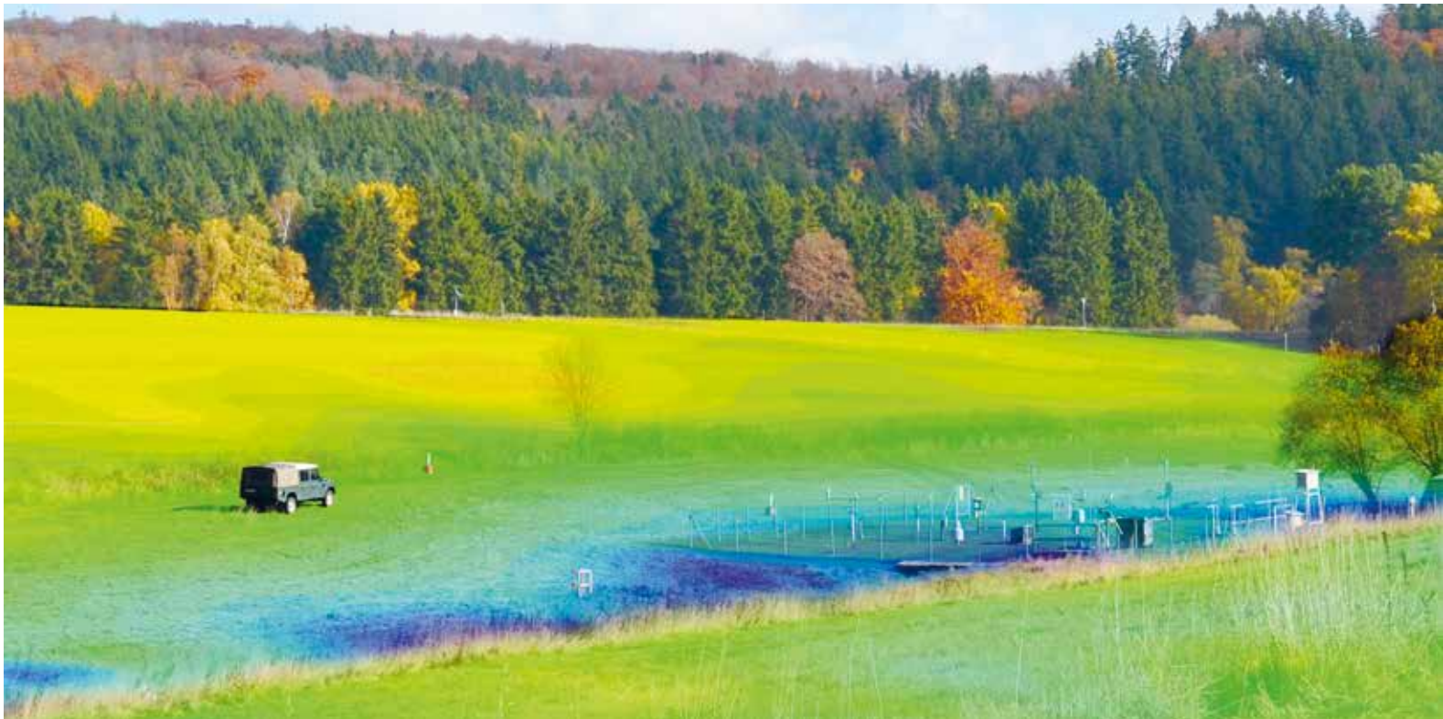
Das Cosmic-Ray-Messgerät im Kofferraum des UFZ-Land Rovers erfasst die Bodenfeuchte in einem Umkreis von 150 Meter und bis in eine Tiefe von etwa 50 Zentimeter.
