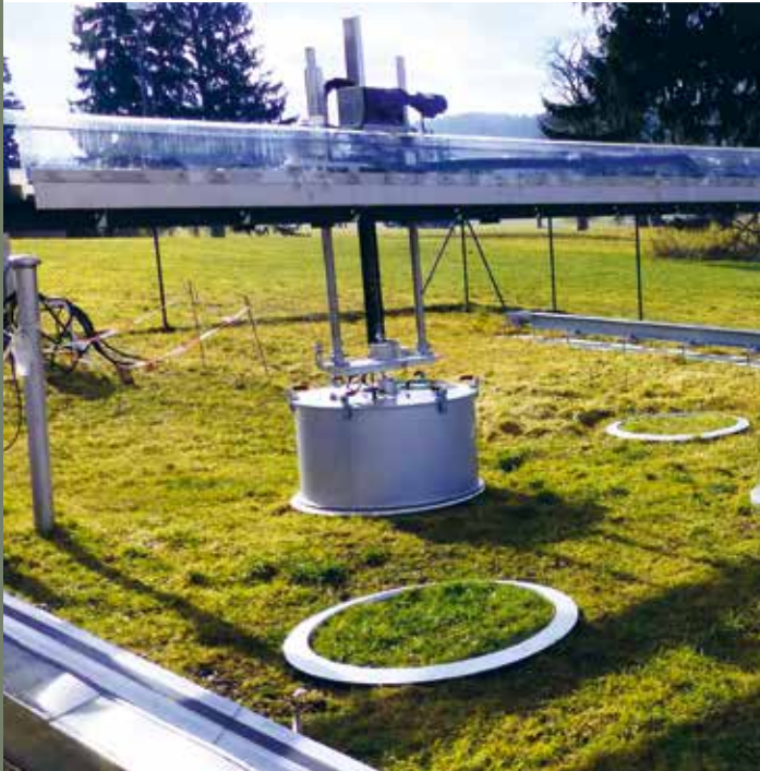
Im TERENO-Observatorium Fendt messen Roboter an Bodensäulen aus verschiedenen Höhenlagen, welche Treibhausgase ihre Mikroorganismen freisetzen.
