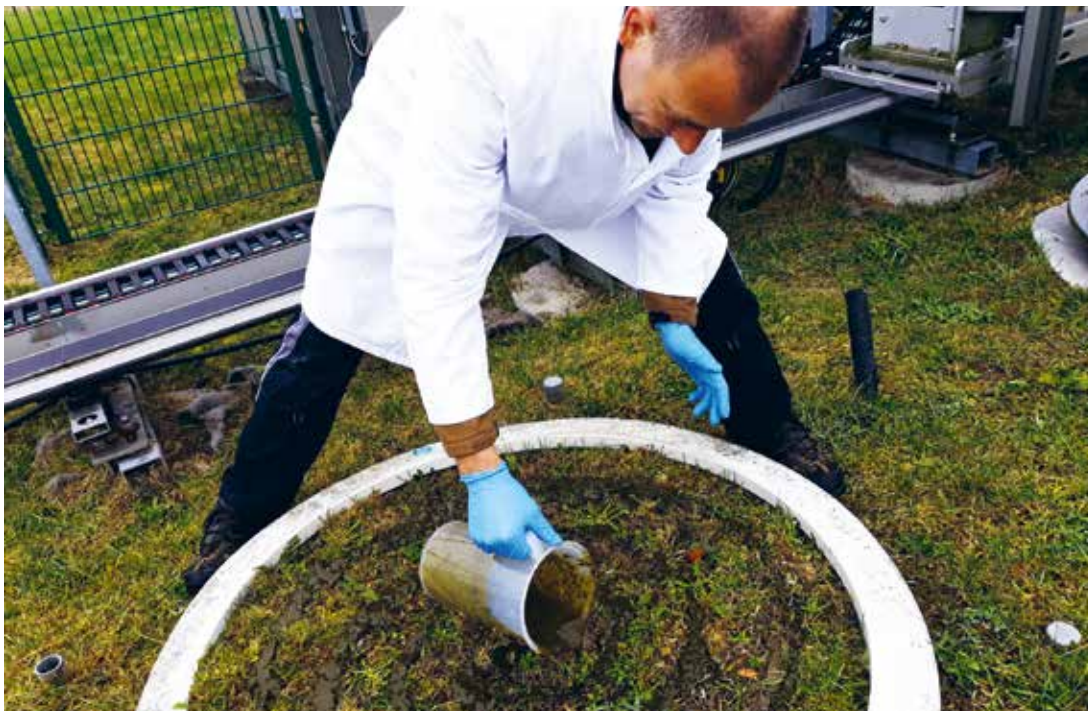
Die Gülle, mit der die Wissenschaftler den Boden in den Lysimetern düngen, ist mit stabilen Stickstoffisotopen angereichert. Mit deren Hilfe können die Umweltforscher genau verfolgen, welcher Anteil der Gülle von Pflanzen aufgenommen wird und was mit dem Rest in der Bodensäule geschieht.
