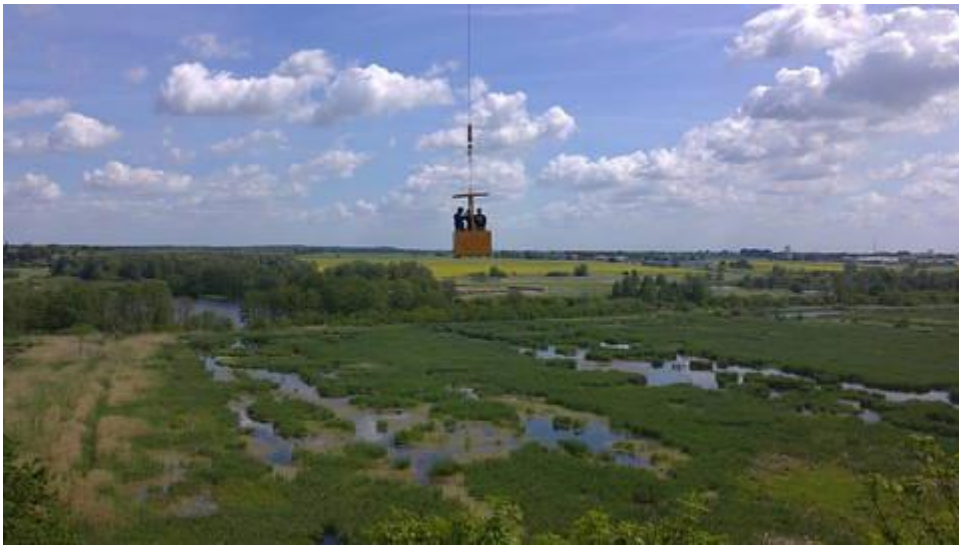
Abbildung 2: Im TERENO Observatorium „Norddeutsches Tiefland“ (Koordination: GFZ) wird die Beprobung von schwer zugänglichen Feuchtgebieten und Baumkronen durch Krananlagen ermöglicht. (Foto: Markus Reich, GFZ)
