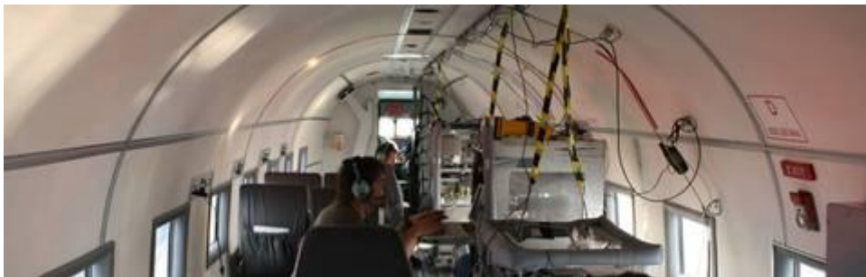
Abbildung 1: Kabinenansicht des Flugzeugs Polar-5 während der Kampagne AIRMETH-2011. Von vorne nach hinten sieht man das MAMap Elektronik-Rack, die Basisdatenerfassung und den in-situ-Methananalysator. (Foto: Torsten Sachs)
